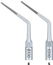
Punta con revestimiento de diamante (40µm) ideal para ampliar el conducto radicular y facilitar así la extracción de limas rotas. No toque la lima rota al ampliar el conducto radicular para evitar que esta se introduzca más en el conducto.
